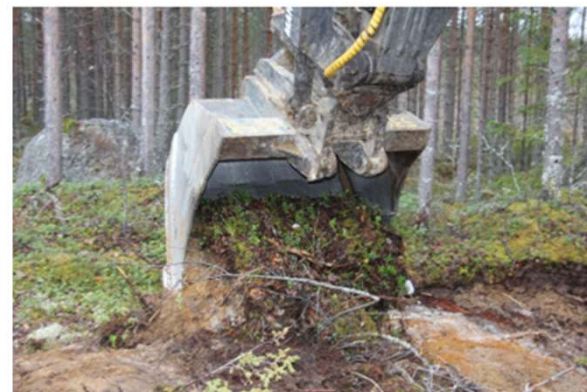
Рисунок 14. Укладка срезанного пласта дерна на поверхность основания в перевернутом виде.
